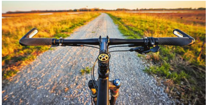
Grusvägscykeln har lite bredare däck, lågt vevparti och tålig ram.
