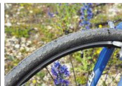
Däcken på en grusvägscykel tjockare än på en vanlig racercykel.
