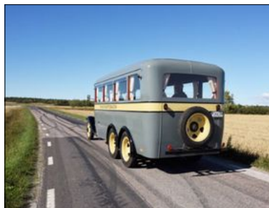
Chevroletbussen från 1931 har dubbla bakaxlar, så kallad boogie-modell. Det gav bättre komfort på de gropiga vägarna.
